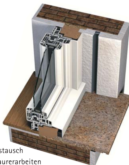
Kombination: Blockblendrahmen mit Classic-line-Flügel
